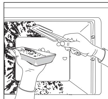
Когда слой льда такой толстый, что его невозможно удалить пластиковым скребком, морозильную камеру необходимо разморозить. Частота
