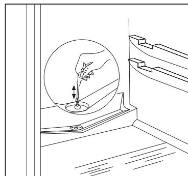
Самый типичный случай засорения сливного отверстия: оберточная бумага продукта, положенного в холодильник, соприкасается с задней стенкой и примыкает к ней. Если в этот момент вы вынете продукт, то бумага порвется и при оттаивании она попадет в сливное отверстие и засорит его.
