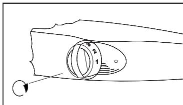
Температура в холодильнике зависит не только от положения термостата, но и от температуры окружающей среды, частоты открывания дверцы холодильника и количества только что положенных и еще не охлажденных продуктов и от других факторов.
